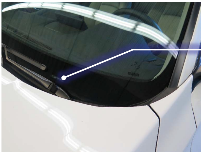
Plaque du NIV située au coin inférieur droit du pare-brise
