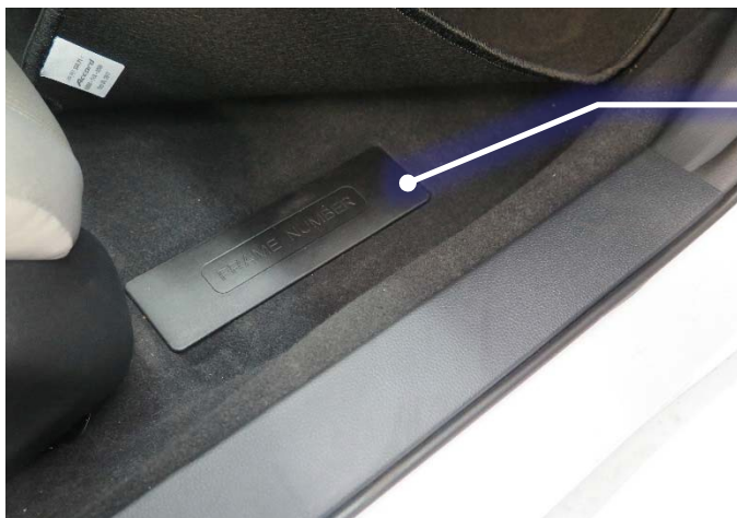
Estampé au plancher, à l'avant du siège du passager, sous le couvercle de plastique portant la mention FRAME NUMBER
